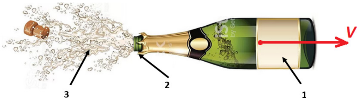
Рис. 6. Бутылка Шампанского, как реактивный двигатель (1 — бак, 2 — сопло, 3 — рабочее тело)
