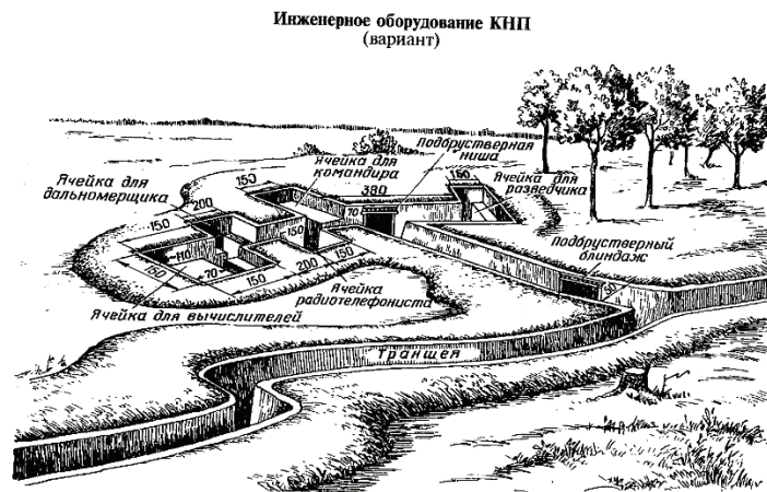
Рис. 6. Командно-наблюдательный пункт как пример элемента фортификации [7]
