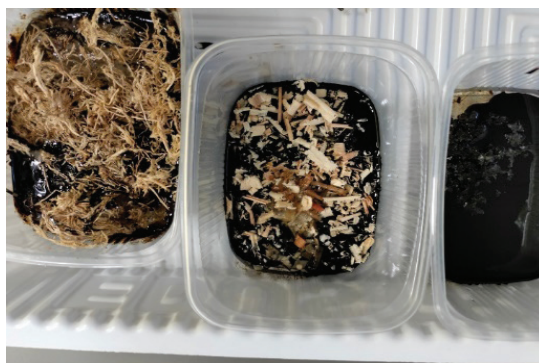
Рис. 1. Определение нефтеемкости сорбентов
