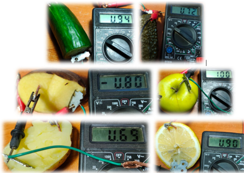
Рис. 2. Тесты напряжения различных природных электробатарей
