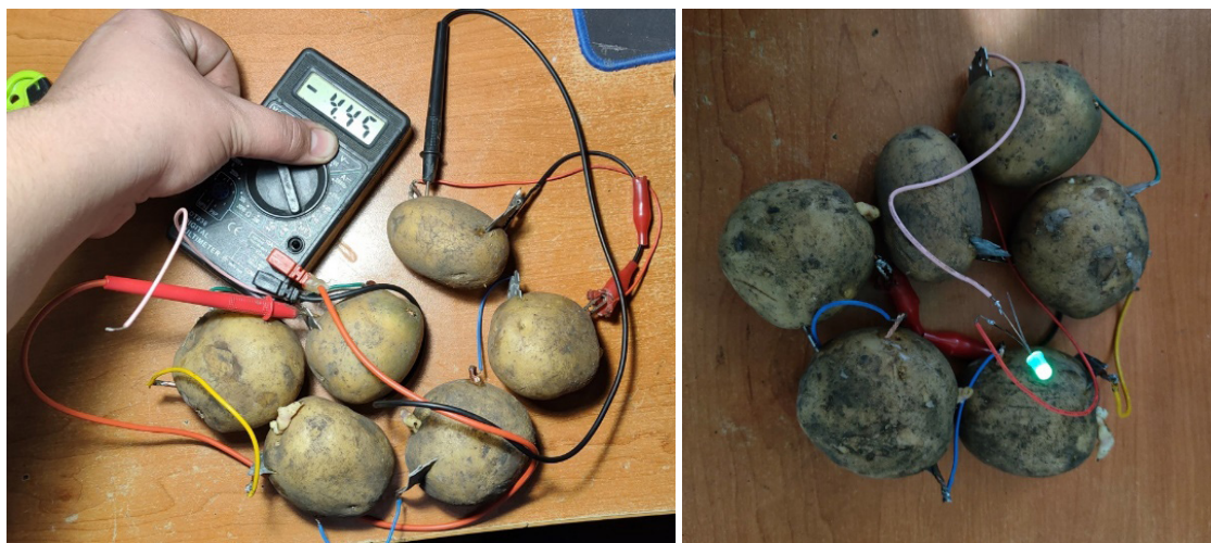
Рис. 3. Измерение напряжения «картофельной» батареи и демонстрация ее работы
