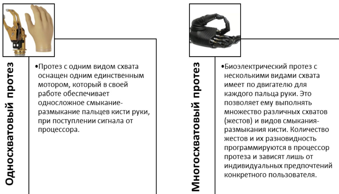
Рис. 1. Типы бионических протезов кисти рук
