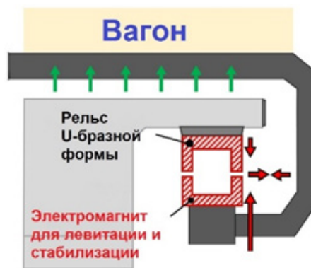
Рис. 5. Единый набор магнитов для левитации и стабилизации
