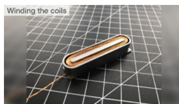
Рис. 18. Самостоятельно созданный электромагнит
