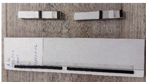
Рис. 35. Изготовленные шаблоны для установки магнитов
