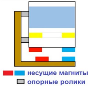
Рис. 21. Поезд на трек с опорой на стену через ролики
