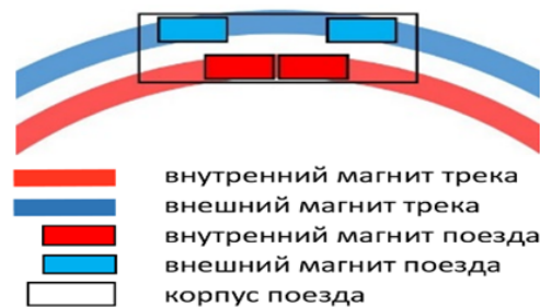
Рис. 26. Размещение несущих магнитов на поезде
