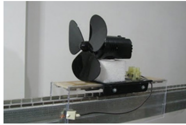
Рис. 15. Макет маглева с приводом-пропеллером
