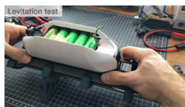
Рис. 19. Испытание распечатанного на 3D-принтере корпуса
