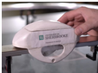
Рис. 17. Макет маглева с охлаждением для сверхпроводимого магнита
