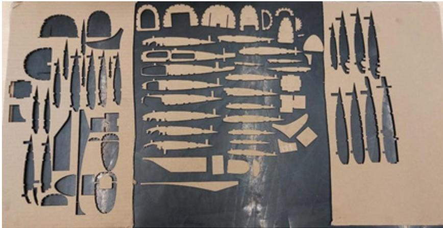
Рис. 3. Готовые детали после процесса резки на лазерном станке
