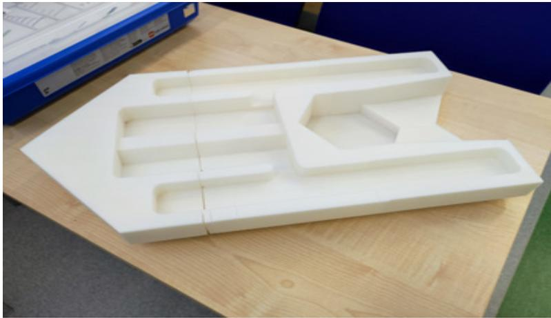
Рис. 4. Нижняя часть макета после печати в сборе
