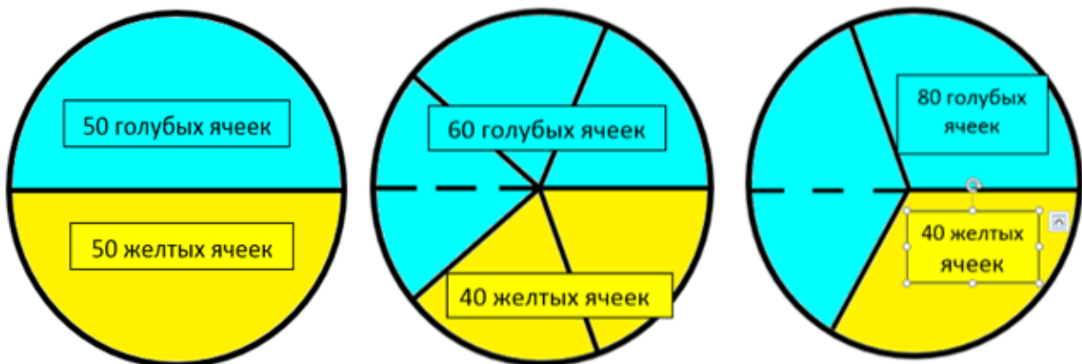
Рис. 3. Количество ячеек, которое должно быть в системе, чтобы возник перколяционный кластер: слева — для треугольной решетки, в середине — для квадратной решетки, справа — для модели пористой структуры
