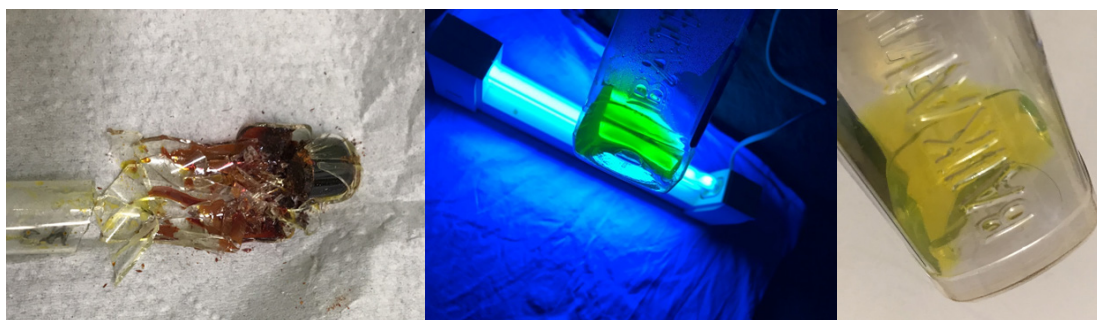
Рис. 8. Разбитая пробирка с твёрдым флуоресцеином, и способный светиться в ультрафиолете флуоресцеиновый раствор
