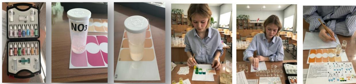
Рис. 6. Определение нитратов, нитритов, железа оборудование для исследования NILPA PRO Plus. Тестирование проб
