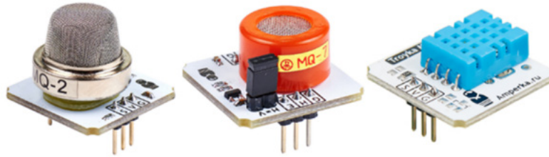
Рис. 4. Примеры датчиков для Arduino: MQ-2, MQ-7, DHT-11
