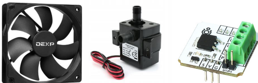
Рис. 6. Вентилятор, погружная помпа и силовой ключ
